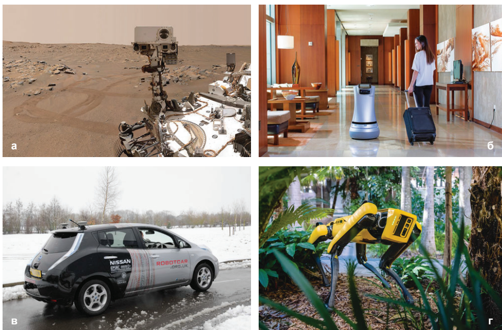
Рис. 1.5. Мобильные роботы: а) марсоход Perseverance на Марсе, автопортрет. На мачте установлено множество камер, включая стереопары, с помощью которых робот может определять трехмерную структуру окружающей среды (изображение предоставлено NASA/JPL-Caltech/MSSS); б) робот-доставщик Savioke Relay (изображение предоставлено Savioke); в) беспилотный автомобиль (изображение предоставлено кафедрой информационной инженерии Оксфордского университета); г) шагающий робот Boston Dynamics Spot (изображение предоставлено Дорианом Цаем)
