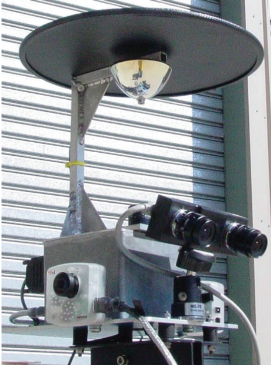
Рис. 1.9. Группа камер на мобильном роботе для наружного применения: стереопара переднего обзора, широкоугольная камера бокового обзора, зеркало с панорамной камерой над головой (мобильный робот CSIRO)
