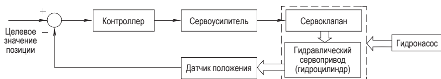
Рис. 2.4 ❖ Структура электрогидравлической сервосистемы
