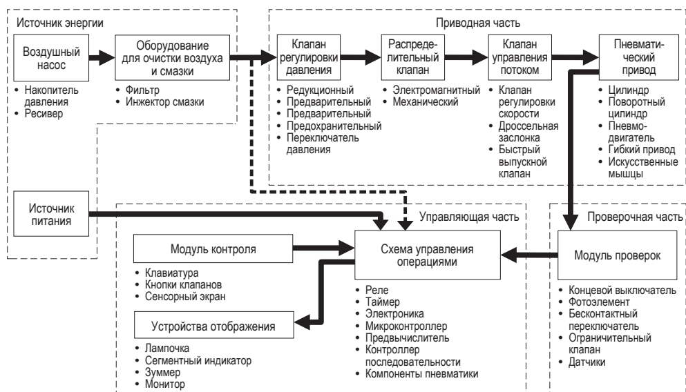
Рис. 2.13 ❖ Состав пневматической системы
