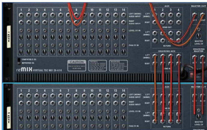
Рис. 1.8. Схема соединения двух микшеров в одну цепь
