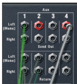
Рис. 1.6. Панель для подключения AUX-эффект-процессоров
