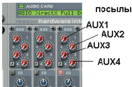
Рис. 1.7. Ручки управления уровней сигналов эффект-процессоров
