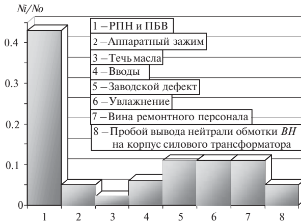
Рис. 1.5. Анализ отказов силовых трансформаторов класса напряжения 110 кВ Чувашской энергосистемы.
