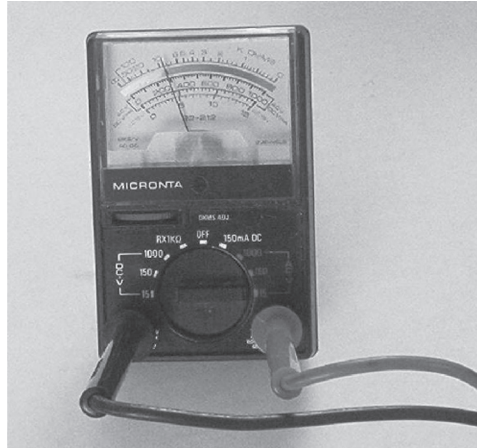
Рис. 1.2. Даже старомодный недорогой аналоговый вольт-омметр, подобный изображенной на рисунке модели Radio Shack, измеряет постоянный ток, как минимум, не хуже осциллографа
