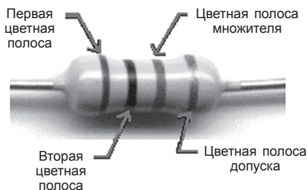
Рис. 1.5. На этой черно-белой фотографии цвет полосок не виден. Однако мы можем прочитать шифр слева направо: две первые описывают целую часть номинала, третья – множитель. Четвертая полоса может быть золотой (5%) или серебряной (10%), характеризуюя допуск значения
