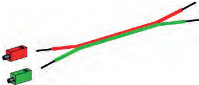
Рис. 1.8. Двухжильный провод и штекеры
