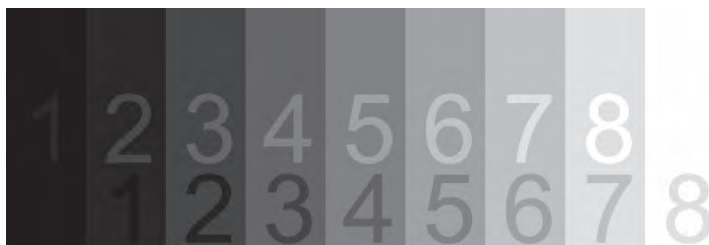
Рис. 1.7. Просматривая это изображение на мониторе, убедитесь, что вы можете различить все числа вверху и внизу
